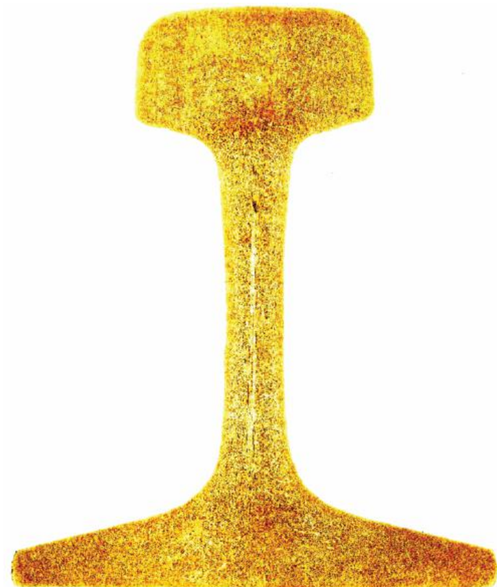
Рисунок И.3 - Обратная ликвация в шейке (серный отпечаток)
