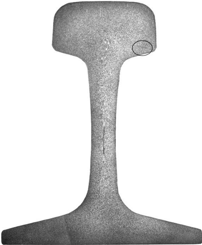
Рисунок И.14 - Одиночные ликвационные полосы с длиной более 5 мм (глубокое травление)
