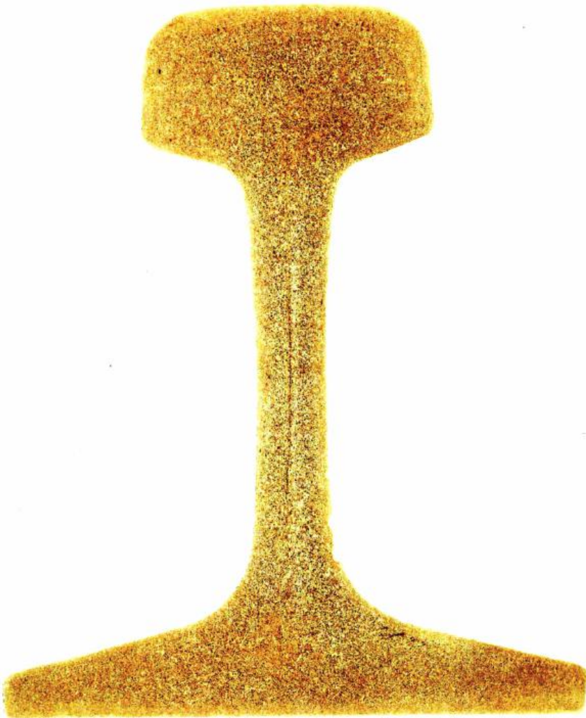
Рисунок И.13 - Ликвационные полосы (серный отпечаток)
