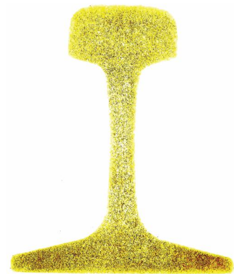
Рисунок И.1 - Макроструктура без ликвации (серный отпечаток)
