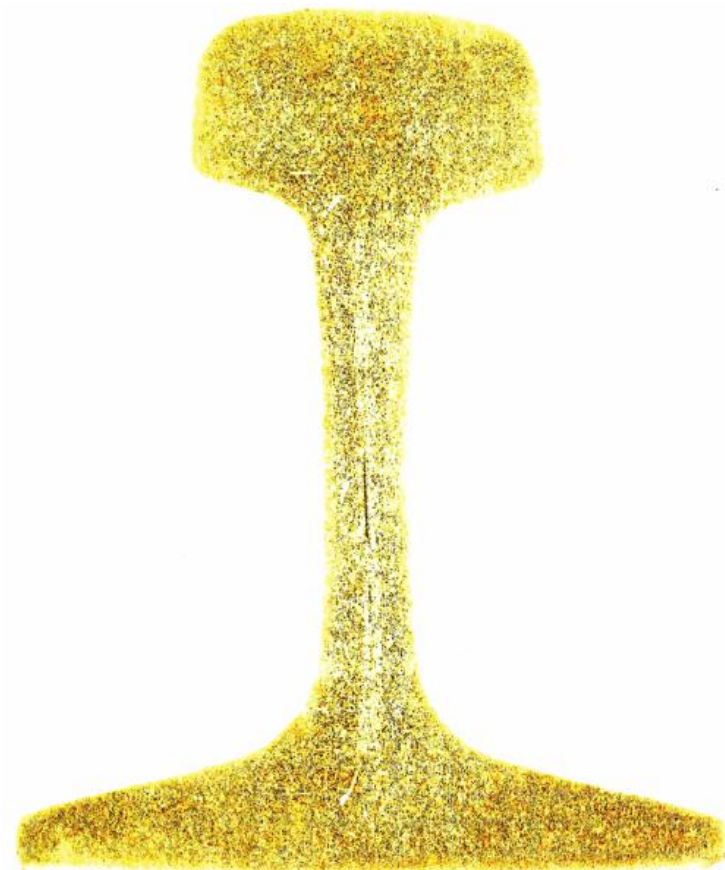
Рисунок И.2 - Незначительная прямая и обратная ликвация (серный отпечаток)
